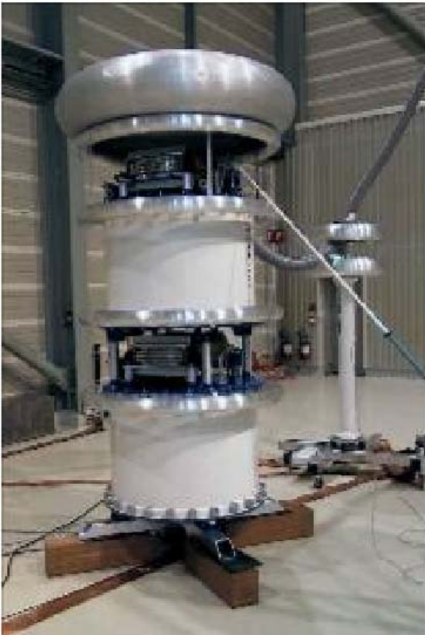
额定值为 200kV; 0.7A 的级联测试变压器
