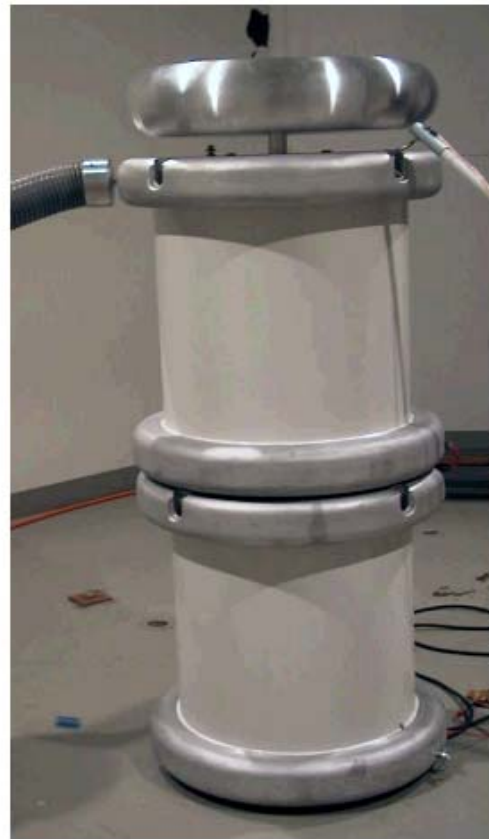
由两个 PZT100-0.1 变压器组成 200kV 级联变压器
