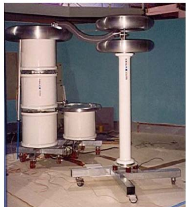
由 4 个 PZTL100-0.25 变压器组成的 300kV 级联变压器
