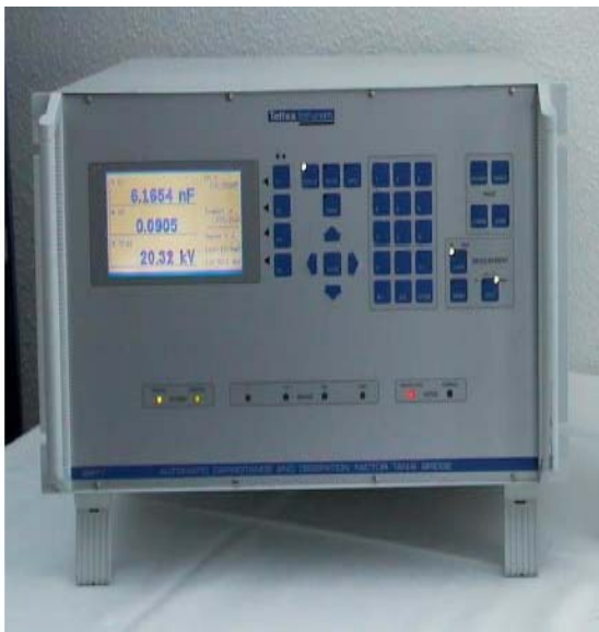
2877型电容和介质损耗正切值电桥 600kV的标准电容器
