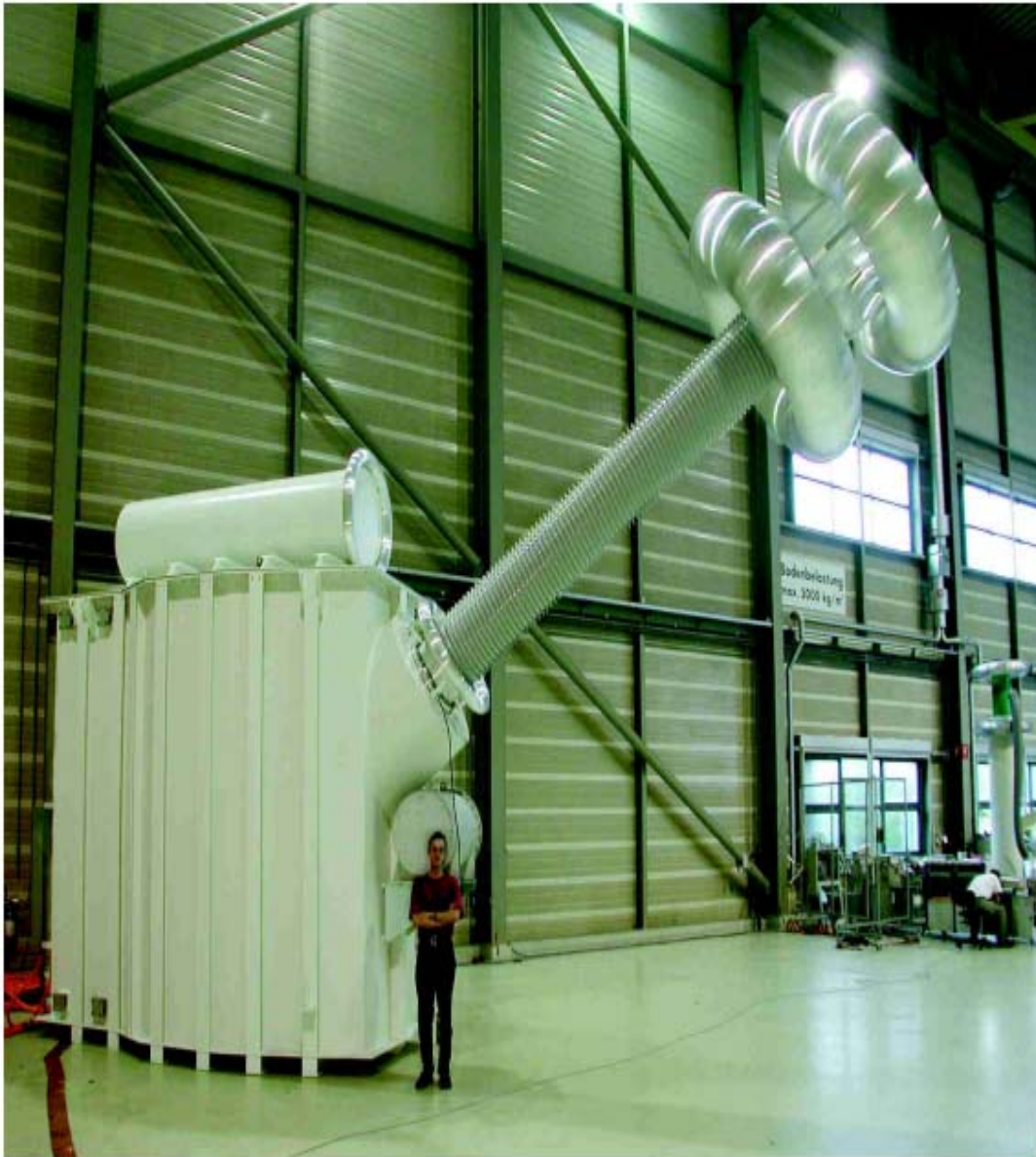
750kV, 2500kVA 箱式试验变压器
