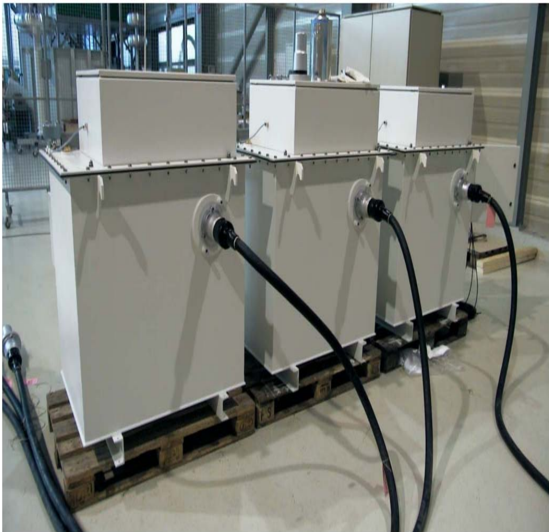
带有中压连接器和电缆的三相70kV测试系统的例子
