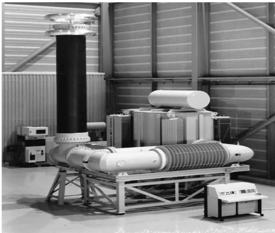
一个带有SF6母线阻尼电阻，耦合电容器和SF6空气套管的700kV, 2100kVA的系统的例子
