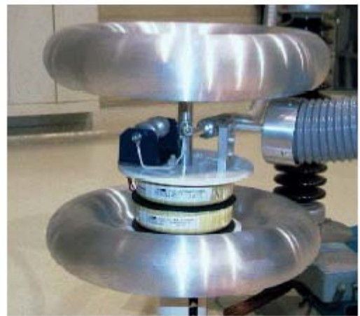
特殊高压滤波电感配置
