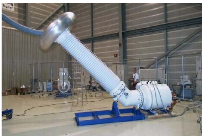
带 SF6 气体套管的 400kV 试验系统
