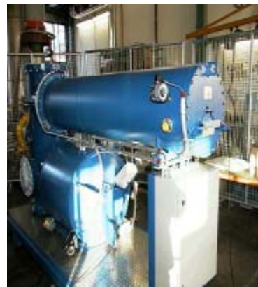
400kV 耦合电容
