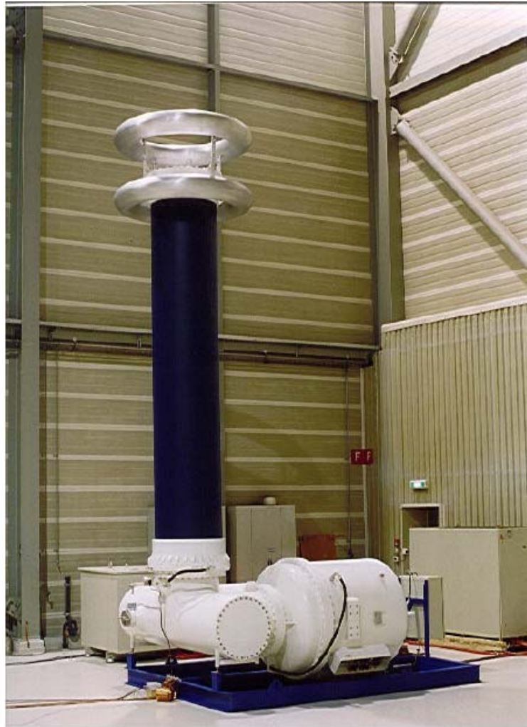
600kV, 250kVA 测试系统(带耦合电容与SF6 气体套管)
