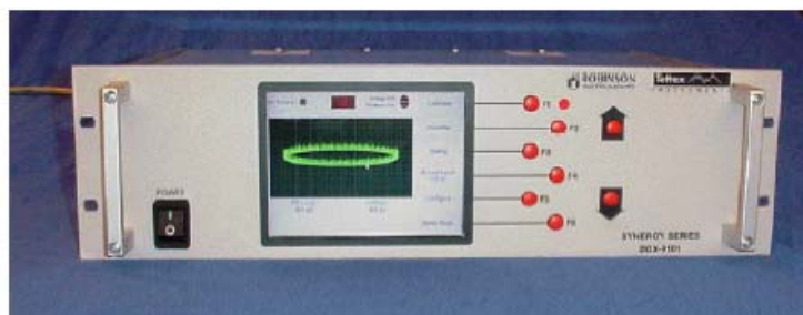
DDX 9101 类型数字局部放电检测器
