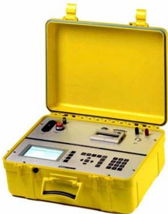
我公司专家极力推荐您采用恢复电压法和RVM 5462恢复电压计进行设备测量。而且，他们将帮助您完成测量结果的分析解释工作。
